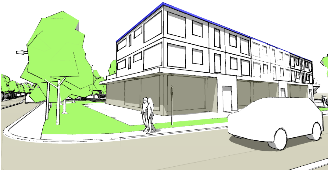
Figure 10 - Rez-de-chaussée commercial d'une hauteur de plafond plus généreuse que les niveaux résidentiels, composition tripartite et aménagement des cours avant pour favoriser l'animation sur rue
