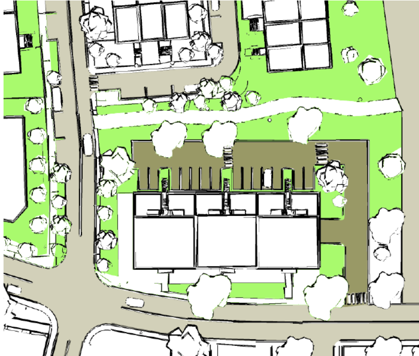
Figure 14 - Exemple de stationnement en cour arrière avec îlots végétalisés et bandes piétonnes, et aire de manœuvre des camions de livraison séparée de l'aire de stationnement
